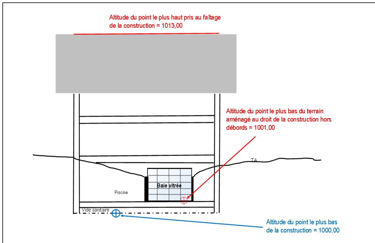
10.3 - La hauteur maximum telle que définie ci-dessus des constructions annexes ne doit pas excéder 4 mètres.
