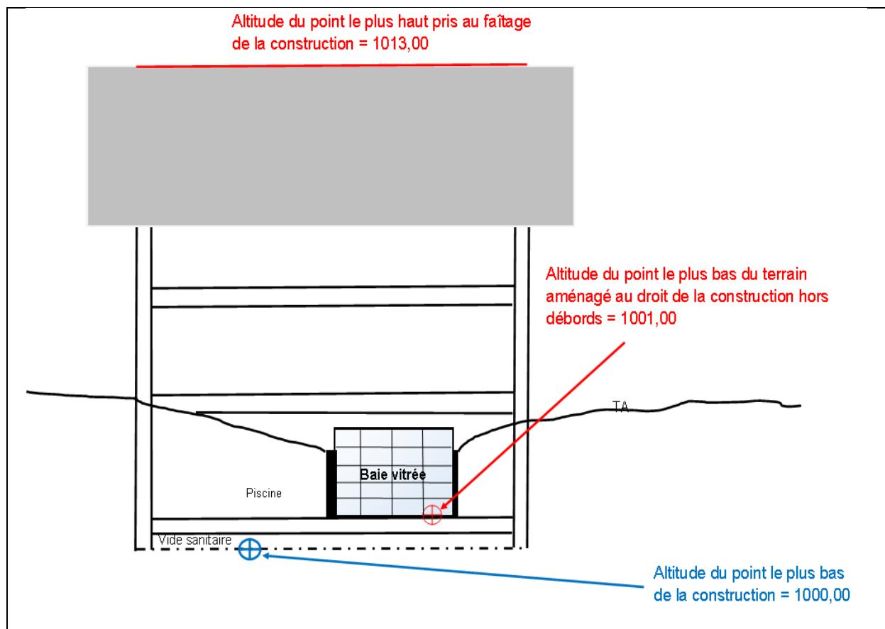
10.3 - La hauteur maximum telle que définie ci-dessus des constructions annexes ne doit pas excéder 4 mètres.
