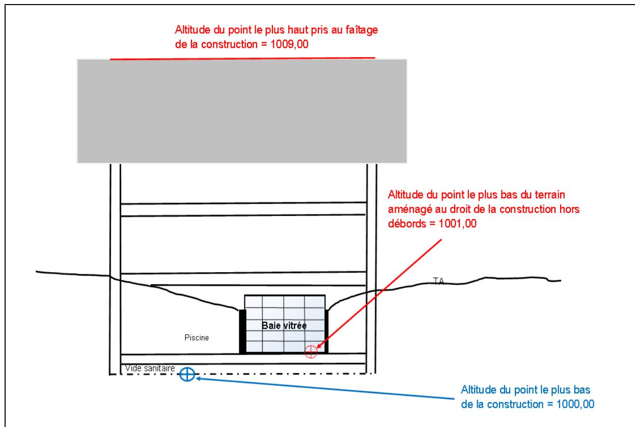
10.3 - La hauteur maximum telle que définie ci-dessus des constructions annexes ne doit pas excéder 4 mètres.
